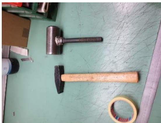
Slika 6: Neustrezno in ustrezno kladivo
